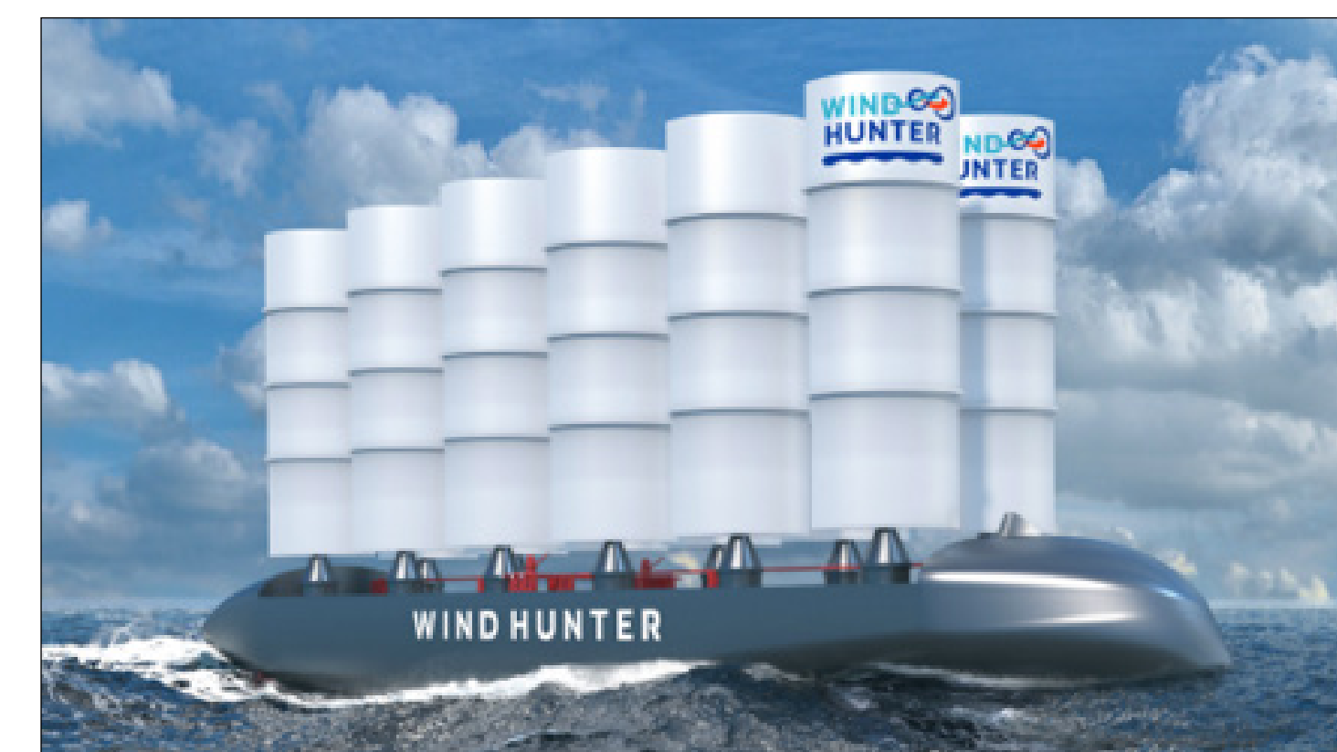
強風時は風力で航行するとともに、風力を使用して水中タービンで発電し、水素を生産・貯蔵します。弱風時は貯蔵した水素を使用し、燃料電池で発電の上、プロペラで推進します。
