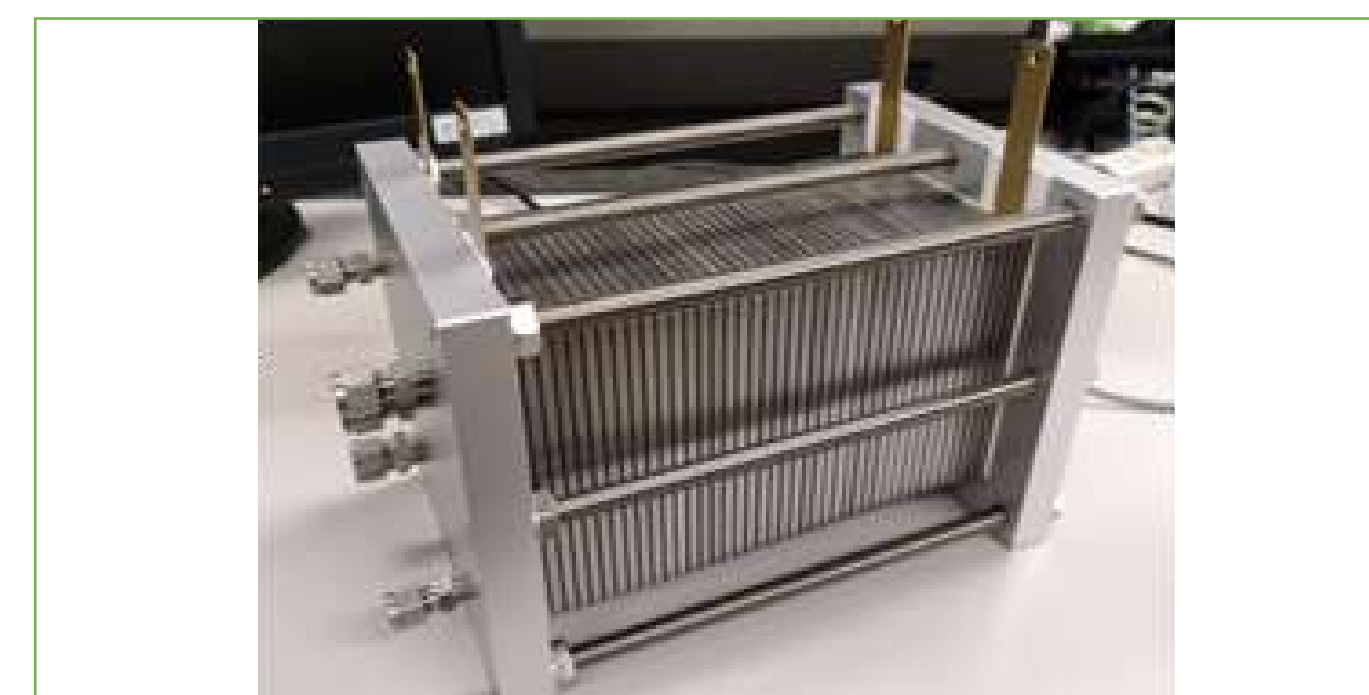
図3 CO 2 電解装置のスタックモデル Fig.3 Stack model of CO 2 electrolyzer
