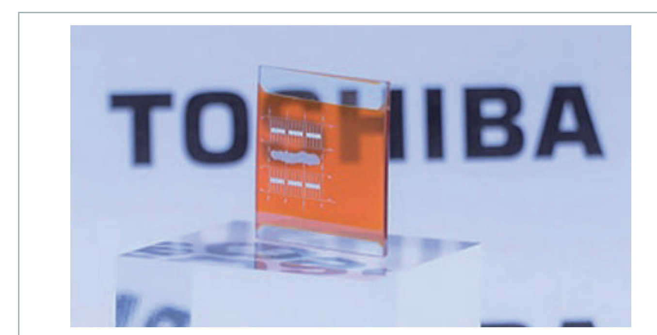
透明 Cu 2 O 太陽電池 Transparent Cu 2 O solar cell
